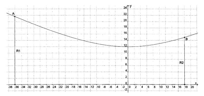
Le volume intérieur de la tour de refroidissement est obtenu par la rotation autour de l'axe des x de la partie du plan délimitée par le graphe de la fonction f définie par  $f(x) = 12 \cdot \sqrt{1 + \frac{x^2}{576}}$ , les droites d'équations x = -36, x = 18 et l'axe des x.
